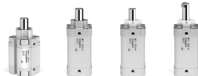
Los cilindros Stopper Serie ST son actuadores neumáticos con vástago, cumpliendo con las normas UNITOP e ISO 21287, donde el vástago y el casquillo han sido específicamente ampliados para garantizar resistencia a cargas radiales y choques. La Serie está disponible en dos versiones, doble efecto y simple efecto, y con muelle trasero. La versión con anti-rotación del vástago también está disponible.
