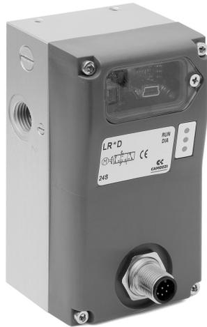
Las electroválvulas proporcionales digitales Serie LR son de 3/3 vías, directamente accionadas con un sistema de corredera giratoria patentada, con un circuito de control de bucle cerrado. La tarjeta electrónica está integrada dentro del cuerpo de la válvula lista para ser conectada.
