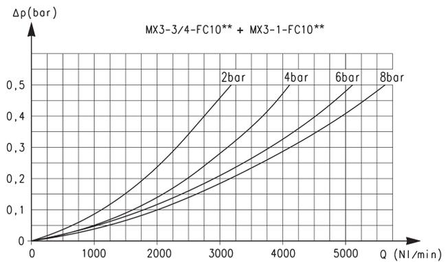
Diagrama de referencia para los modelos con elemento filtrante = 1 µm
